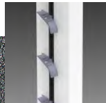
Selbsttragende seitliche Gleitschienen aus extrudiertem und silbereloxiertem Aluminium in den Abmessungen 85x40, Dicke 1,9 mm, die für leises Gleiten mit in den Drehzapfen eingelassenen PVC-Einsätzen ausgerüstet sind.
