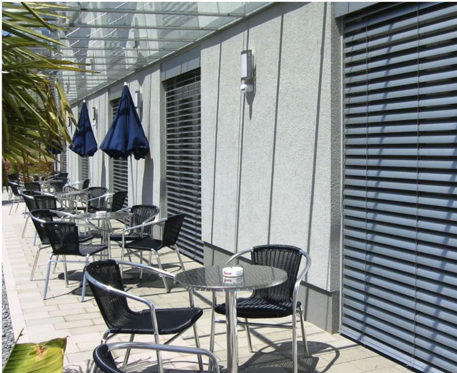
Les stores à lamelles convexes AB65 et AB80 constitués de lamelles d'une largeur de 65 mm et 80 mm protègent contre l'éblouissement et garantissent un réglage optimal de la lumière. Ils sont particulièrement adaptés aux façades classiques et la profondeur de niche nécessaire ne dépasse pas 100 mm ou 120 mm.
