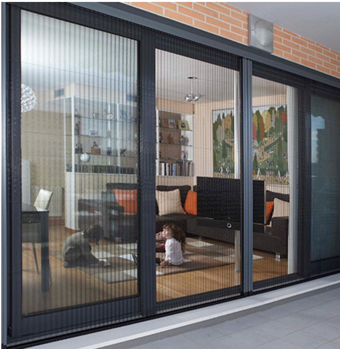
Cette moustiquaire s'ouvre et se ferme à la manière d'un accordéon et convient parfaitement pour les portes-fenêtres grâce à son seuil minimal. Elle est munie d'un treillis en PVC et se manoeuvre manuellement. Le guidage au sol de 3 mm d'épaisseur ne constitue pas un obstacle au passage. Armature en aluminium éloxé naturel ou thermolaqué en blanc, bronze, brun ou anthracite. Profil de fermeture muni d'une brosse d'étanchéité.
