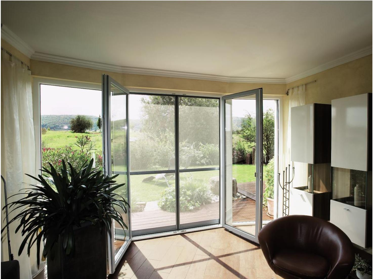
La porte battante s'ouvre facilement de l'intérieur, et elle peut être équipée en option d'une traverse large et d'un ferme-porte automatique. Grâce au profilé à brosse réglable au bas de la porte, la porte battante se passe totalement de profilé au sol.
